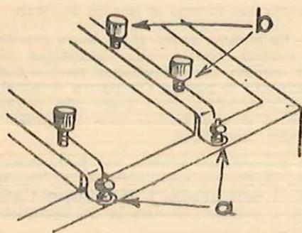
d) Vous remplacez la plaque à encreur. Vous ramenez les tringles transversales à leur place, vous vissez à fond les vis de fixation de ces tiges transversales (en a).
