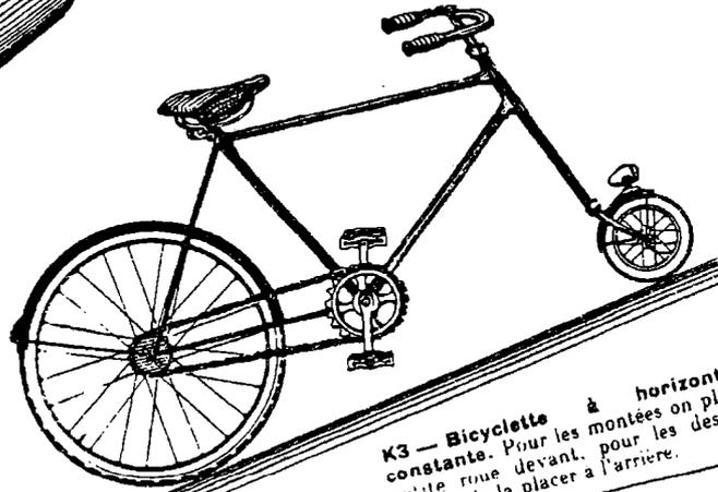
K3 — Bicyclette à horizontalité constante. Pour les montées on place la petite roue devant, pour les descentes il suffit de la placer à l'arrière.
